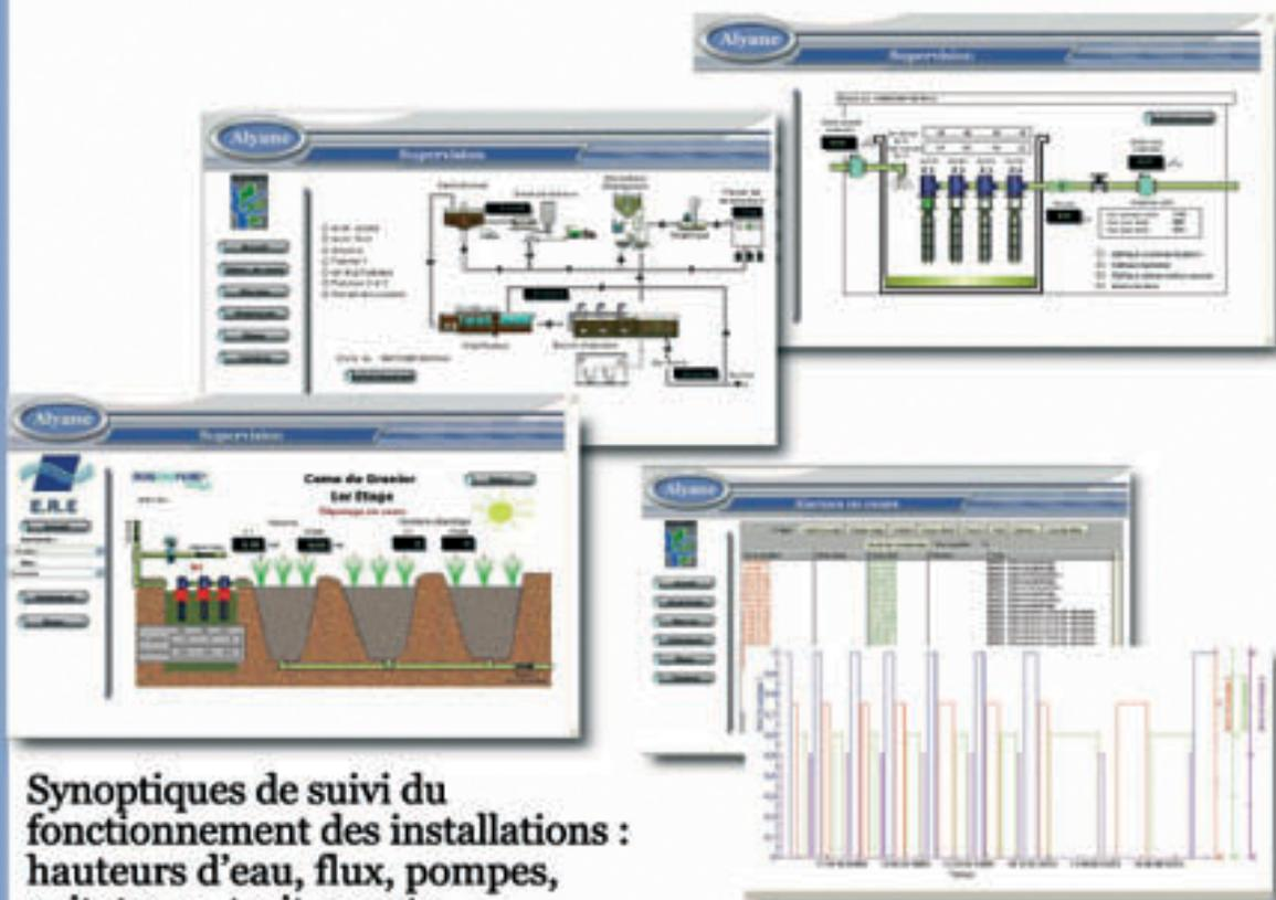
Synoptiques de suivi du fonctionnement des installations : hauteurs d'eau, flux, pompes, agitateurs, traitements ...
